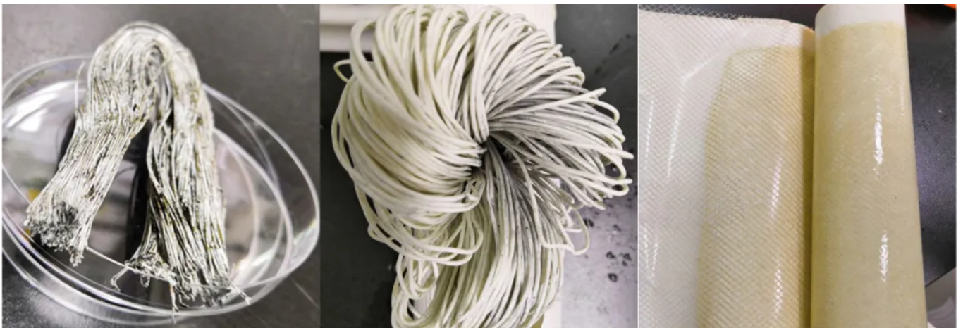
图1 净水器中膜组件的污染
